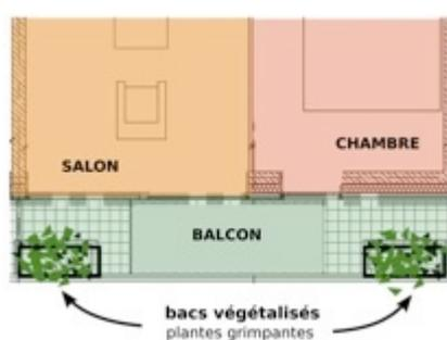
Figure 3a : Situation de la façade végétalisée sur les balcons du bâtiment A.
