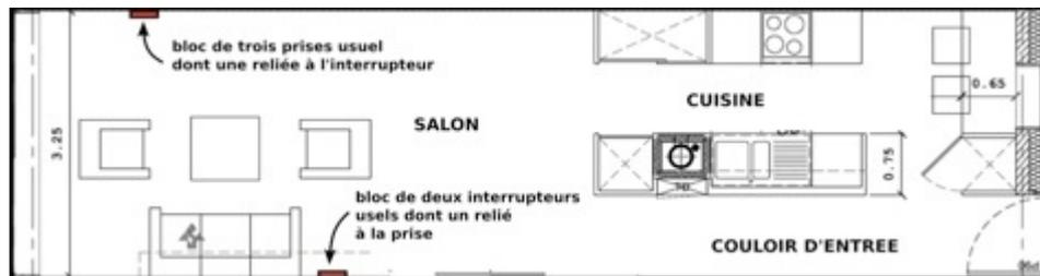
Figure 2 : Situation de l'interrupteur coupeur de prises dans le logement. Source : Renauld, 2012.
